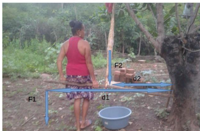
Figura 2. Esquema da alavanca inter-resistente.
