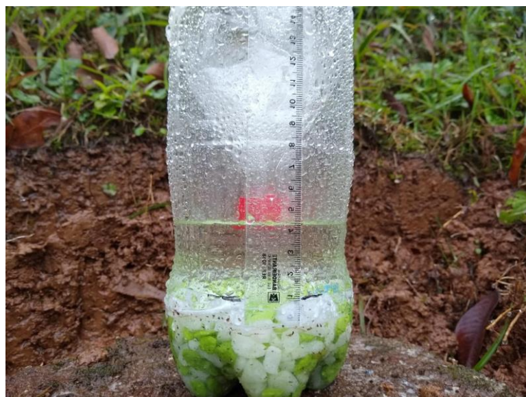
Figura 4. PluvioPET construído conforme orientação do professor pesquisador da EE MHD Caetano (Foto: Lucas).
