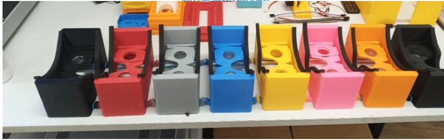
Figura 1 – Óculos confeccionados na impressora 3D.
