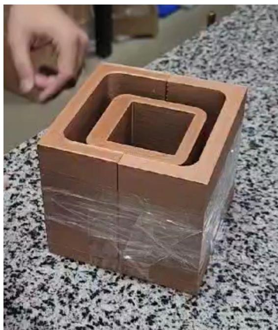
Figura 4: moldes impressos em impressora 3D em PLA dourado, sendo preparados para receber a bio cerâmica
