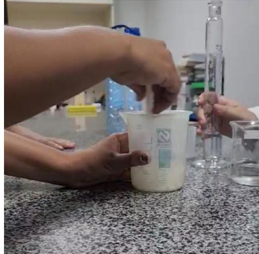
Figura 6: preparo da bio cerâmica – trituração das cascas de ovos e mistura do alginato de sódio e água.
