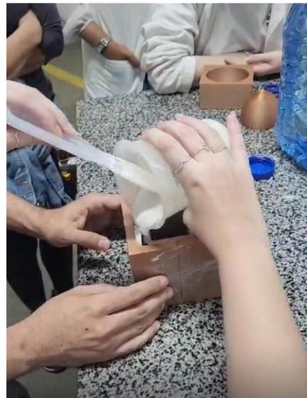
Figura 7: colocação da bio cerâmica nos moldes de PLA
