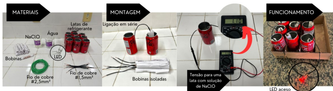
Figura 1: Processo de confecção da bateria e funcionamento. (Autoria Própria)
