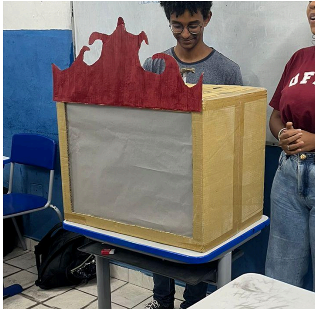
Figura 2. Caixa de papelão com a face anterior recortada e preenchida pelo papel manteiga com o painel devidamente posicionado, ao fundo dois dos autores deste estudo.
