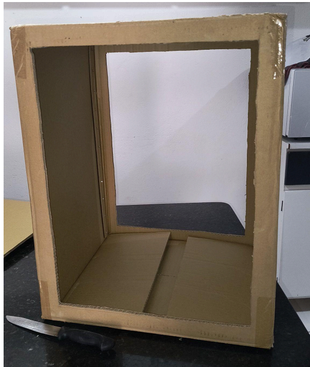
Figura 1. Caixa de papelão com as faces laterais de maior tamanho recortadas em formato retângular.
