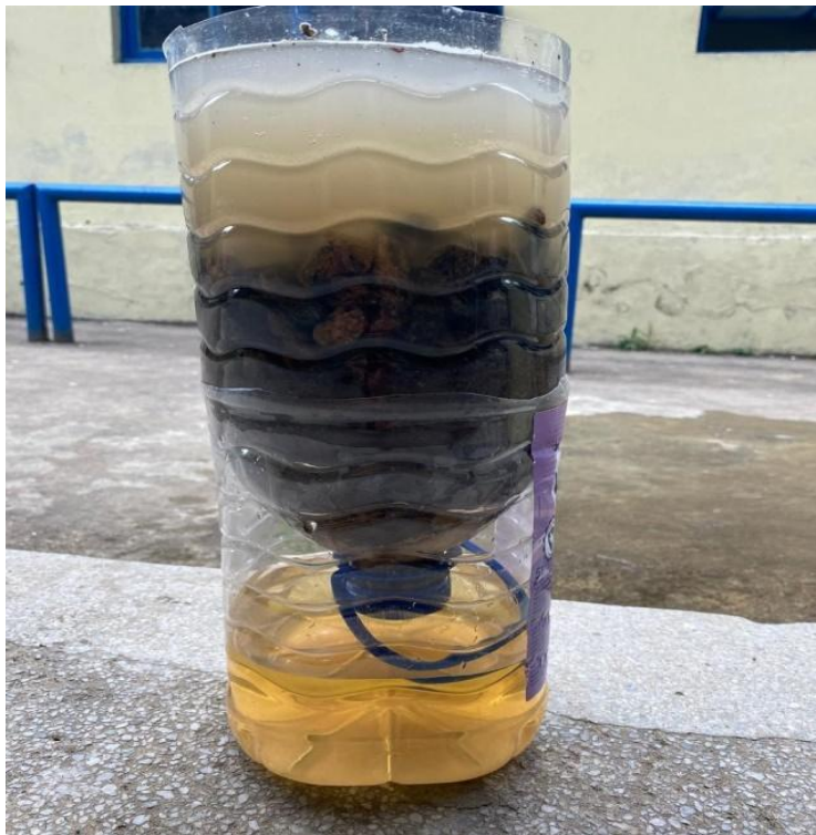
Figura 2 – Teste dos filtros de águas cinza construídos pelos estudantes
