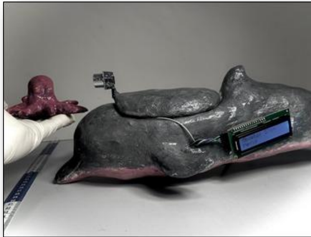
Figura 2: Sensor ultrassônico e monitor LCD medindo a distância de 11cm (perto) no modelo.
