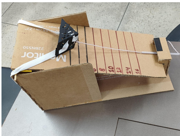
Figura 1: Vista superior da catapulta mostrando o sistema de mudança de posição e lançamento.
