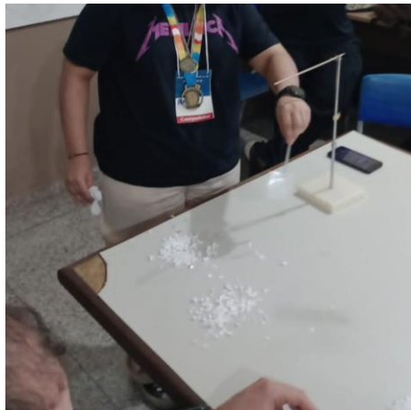
Figura 9. Discente do ensino médio realizando teste de eletrização por atrito com o canudo.
