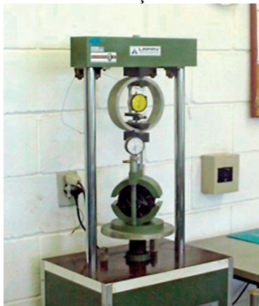
Figura 2: Corpo de prova submetido à ruptura na Prensa Marshal.
