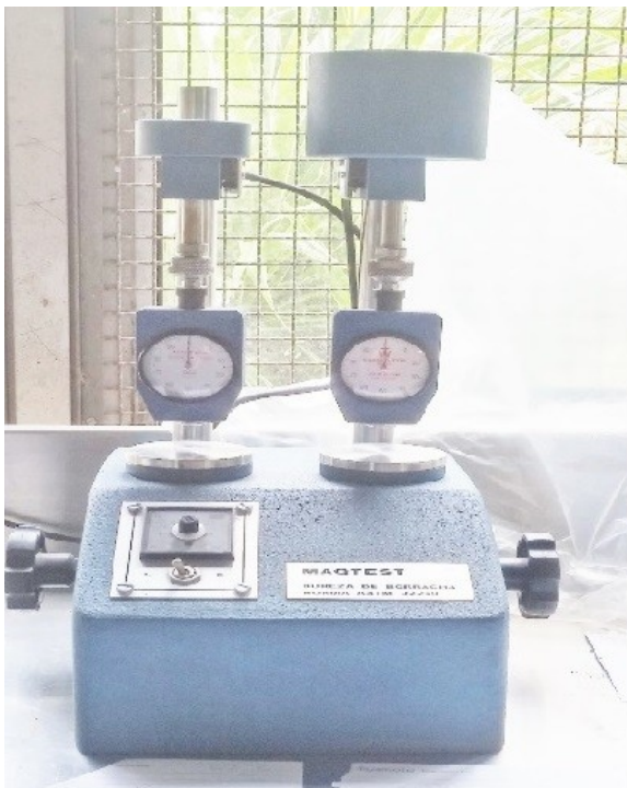
Fig. 8 Durômetro Shore A e Corpo de prova para aferir dureza
