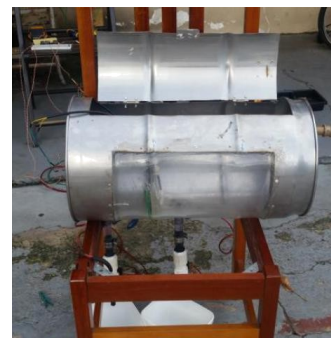
Figura 14: Preparação do vaso separador para os testes.
