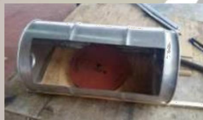
Figura 1: Janela de acrílico sendo fixada.
