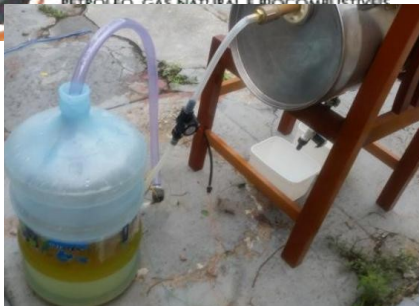
Figura 15: Reservatório contendo água e óleo misturados.
