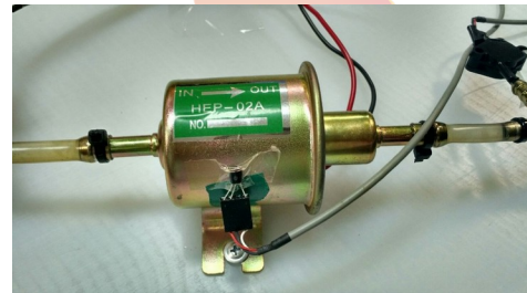
Figura 10: Bomba hidráulica e sensor de temperatura acoplado
