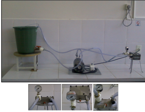
Figura 2: Sistema de filtração com ampliação célula de filtração exposta abaixo.
