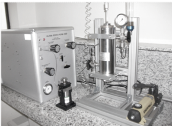
Figura 4: Equipamento utilizado para a realização do ensaio de densidade de grãos e porosidade: Ultra Poro/Perm 500.
