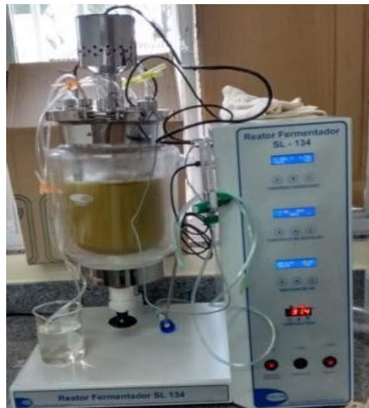
Figura 1: Fermentador utilizado para os experimentos em batelada.
