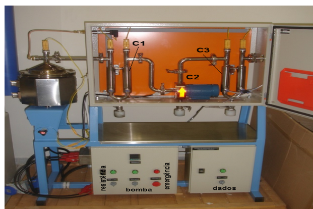
Figura 1: Esquema do Pirolisador usado neste trabalho, composto por um reator, um transdutor de pressão próximo ao reator, um controlador de pressão com válvula de esfera na saída do sistema, sistemas de controle de emergência (forno e centrífuga) e de sistema de aquisição de dados.
