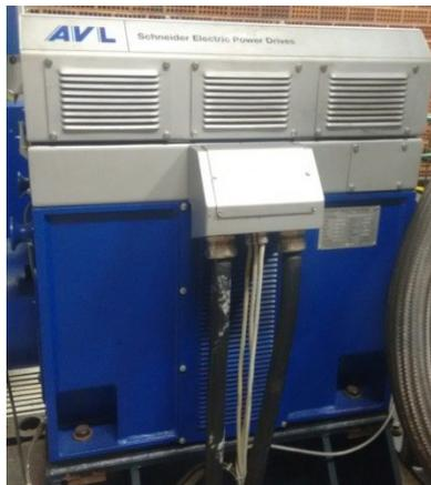
Figura 2: Dinamômetro AVL
