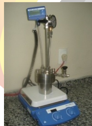
Figura 2 - Fotografia do reator de aço inox utilizado para obtenção de biodiesel.
