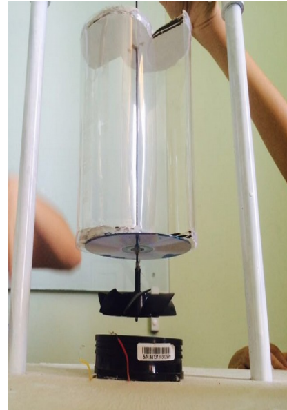
Figura 5. Rotor de cooler de 12V acoplado ao eixo.
