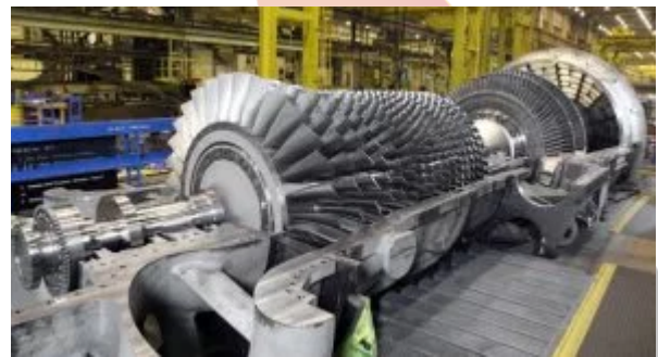
Figura 1: Turbina a Gás fabricante GE.
