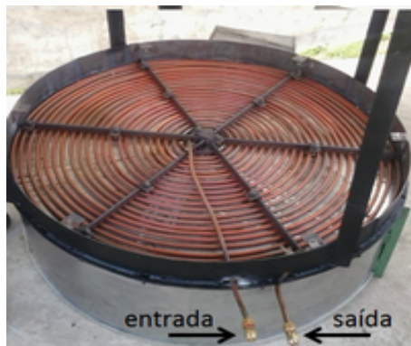
Figura 7. Detalhe da serpentina instalada no fundo do forno para torrar a farinha.
