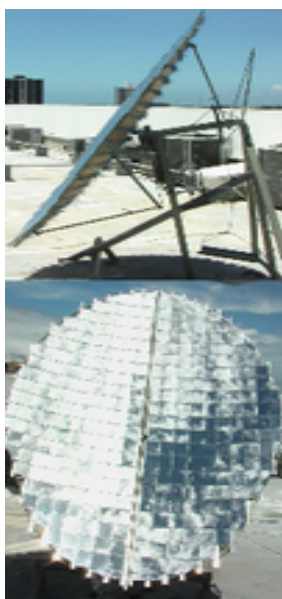
Figura 2. Concentrador solar utilizado neste trabalho [Dib, 2009].
