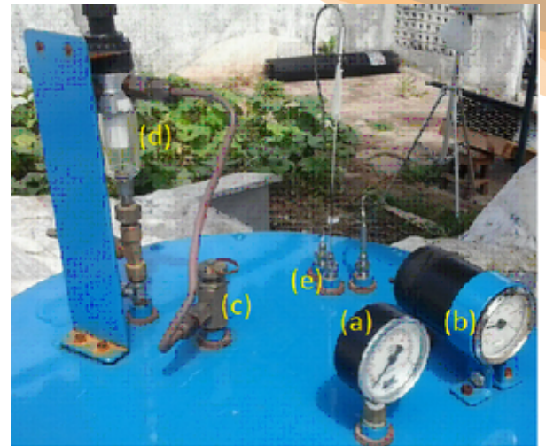
Figura 4. Forno absorvedor híbrido solar/gás. (a) Manômetro. (b) Termômetro. (c) Válvula de segurança. (d) Sistema para armazenamento da purga. (e) Conexões para termopares.
