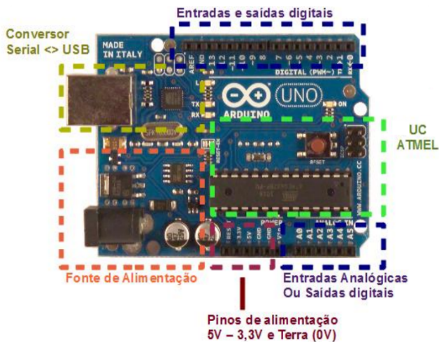
Figura 4: Pinagem do Arduino UNO
