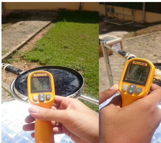
Figura 8. Frigideira, com frango, colocada no foco do concentrador solar e o multímetro fazendo a leitura da temperatura na panela.
