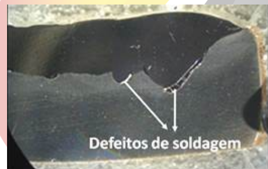
Figura 6: Defeitos de soldagem para o processo MIG-MAF. Ampliação: 8x. Ataque nital (1,5%)
