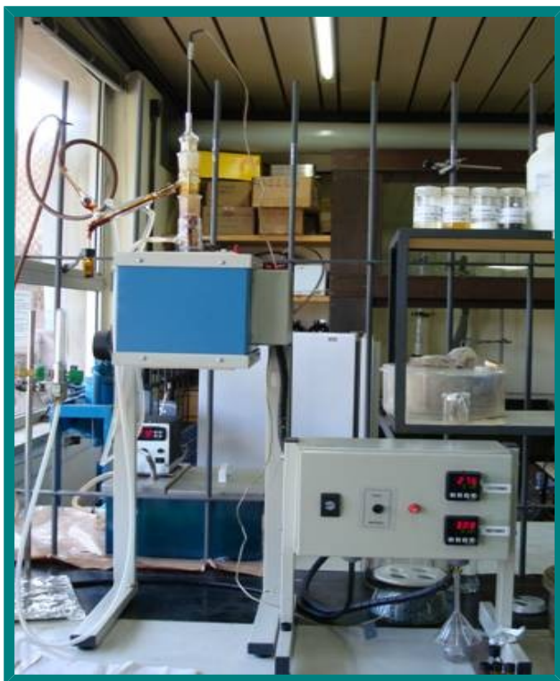
Figura 1: Foto do forno de pirólise usado para a obtenção do alcatrão.
