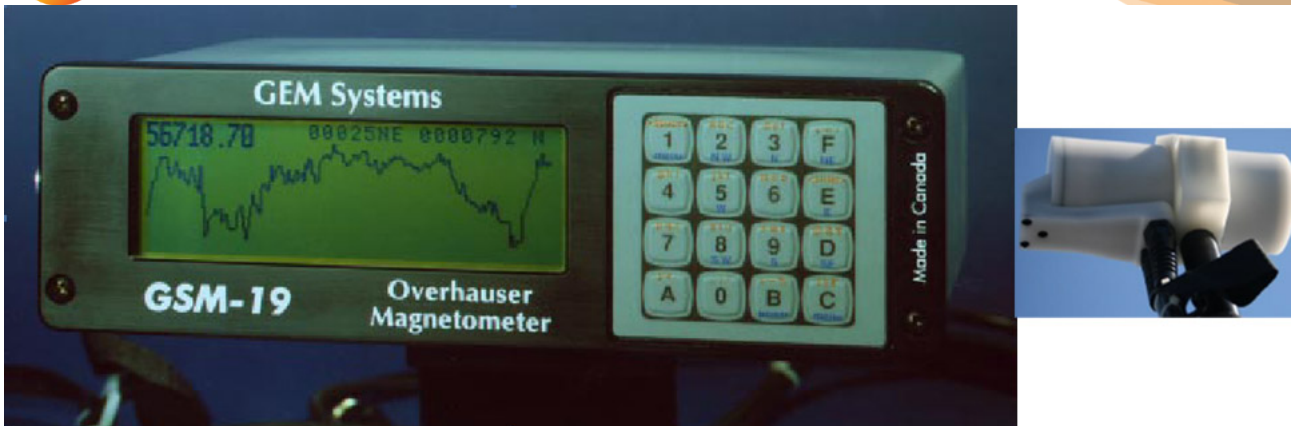
Figura 3 - Magnetômetro GSM 19 e o respectivo sensor usado em estudos geofísicos na área do Parque do mico Leão Dourado – Cabo Frio – RJ
