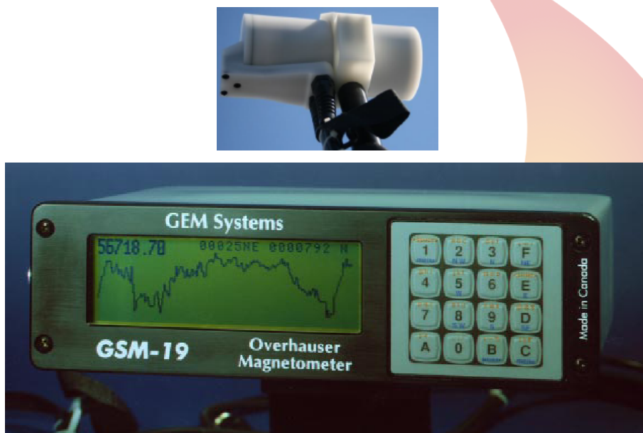
Figura 6 - Magnetômetro GSM 19 e o respectivo sensor usado em estudos geofísicos na área do Parque do mico Leão Dourado – Cabo Frio – RJ
