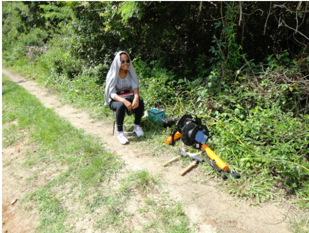
Figura 5: Disposição final dos equipamentos de eletroresistividade (Fonte: o autor).
