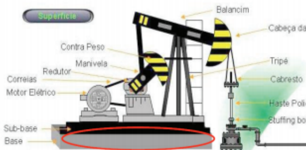
Figura 2: Unidade de Bombeio Mecânico.
