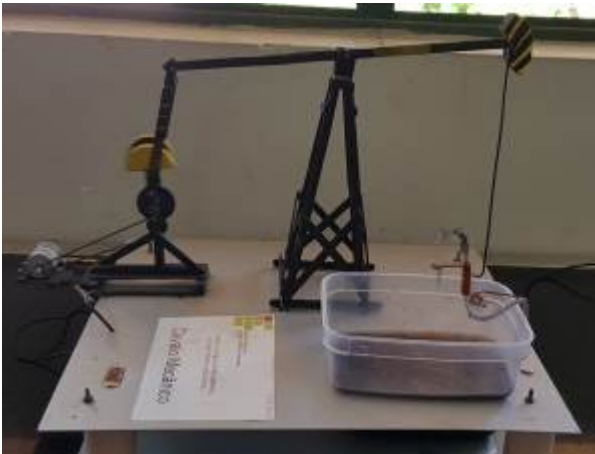
Figura 5: Unidade de bombeio mecânico didática em funcionamento. [Fonte: Autores, 2016].
