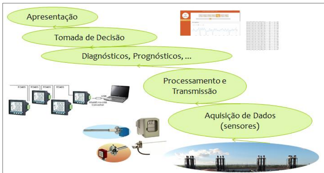
Figura 2 – Visão geral das camadas do sistema de monitoramento contínuo de emissões atmosféricas.
