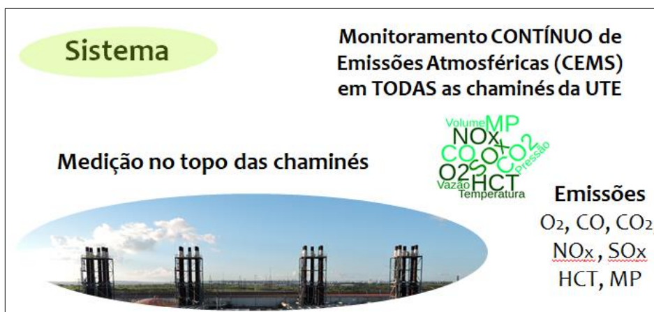
Figura 1 – Visão geral do sistema de monitoramento contínuo de emissões atmosféricas.
