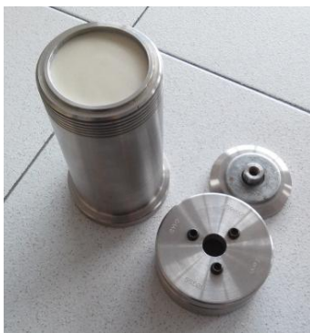
Figura 3 – (a) Célula de envelhecimento, (b) Equipamento Fann Estufa Rotativa Roller Oven. Fonte: Laboratório de fluidos do IFBA, 2016.
