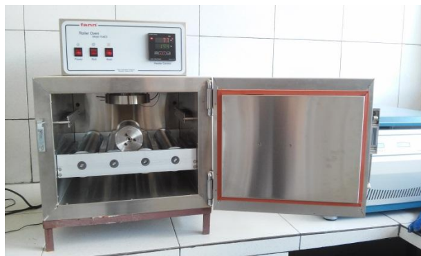
Figura 3 – (a) Célula de envelhecimento, (b) Equipamento Fann Estufa Rotativa Roller Oven. Fonte: Laboratório de fluidos do IFBA, 2016.
