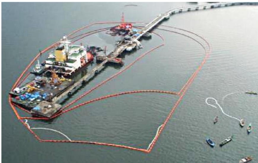
Figura 6 : Barreiras de prevenção colocadas ao redor do barco responsável por desembarcar barris de óleo
