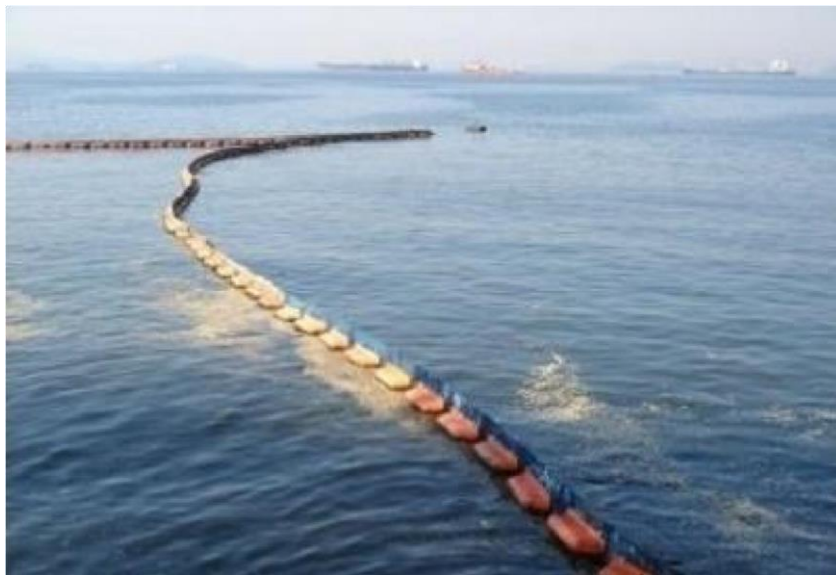
Figura 4: Barreira absorvente, responsável por conter o avanço do óleo de derramamento
