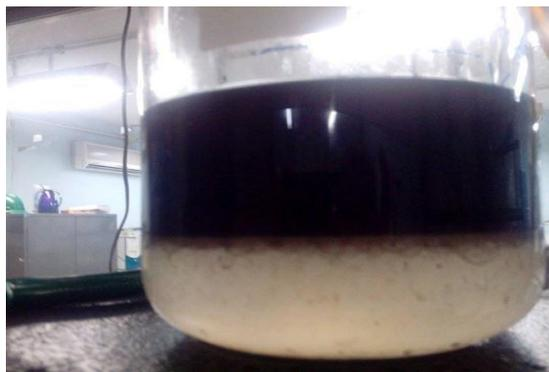
**Figura 1:** Amostra de água produzida cedida pela PETROBRAS.
