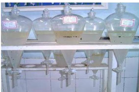
**Figura 2:** Funis de separação apresentando fases não separadas totalmente.
