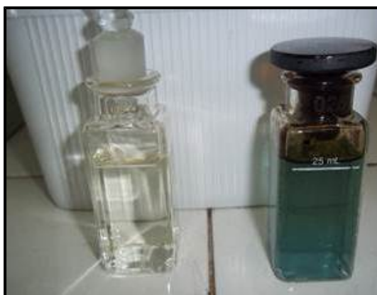
Figura 02 – Amostras em cubetas prontas para leitura- O azul forte demonstra grande concentração de enxofre
