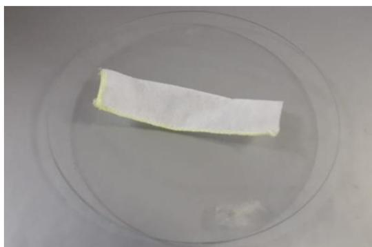
**Figura 1.** Mini-barreira de contenção confeccionada com TNT
