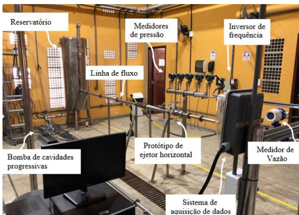
Figura 3. Sistema de escoamento laboratorial com ejetor gás/líquido acoplado.
