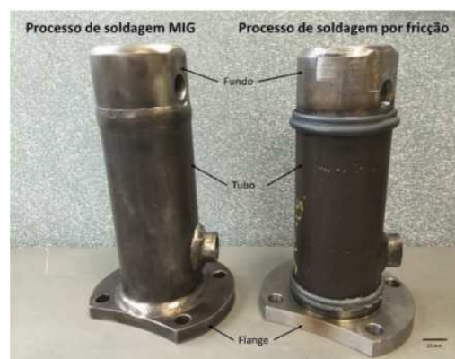
Figura 1 - Conjunto camisa de cilindro hidráulico soldado nos processos MAG e fricção (SBACHIERO, 2016)
