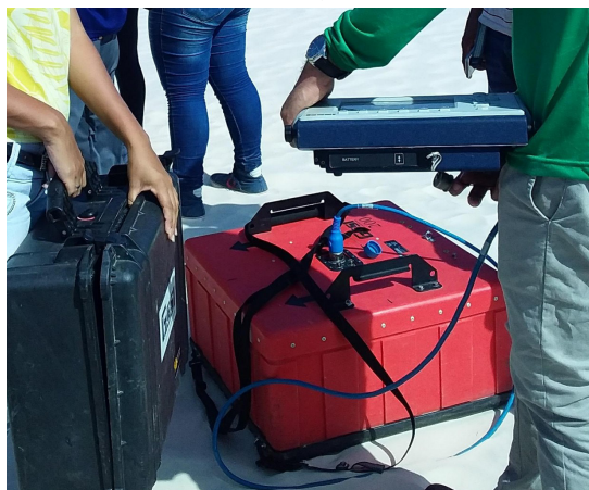
Figura 1. Equipamento geofísico GPR para estudar a estratigrafia das dunas eólicas do Atalaia (Salinópolis, Pará).
