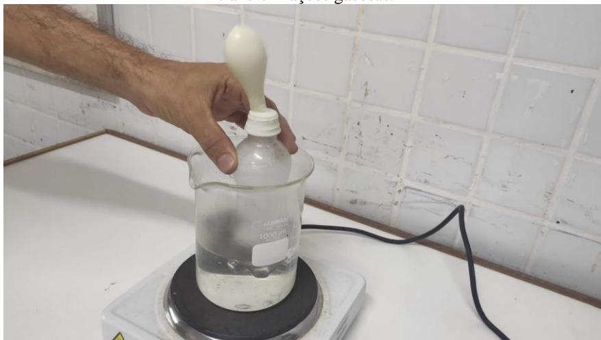
Figura 6: Garrafa com bexiga na tampa parcialmente imersa em água quente, como parte da prática sobre transformações gasosas.
