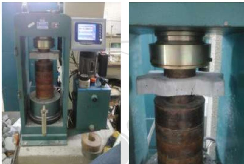
Admite-se que a resistência à compressão obedece à distribuição normal, sendo o valor característico estimado pela Equação 1:
