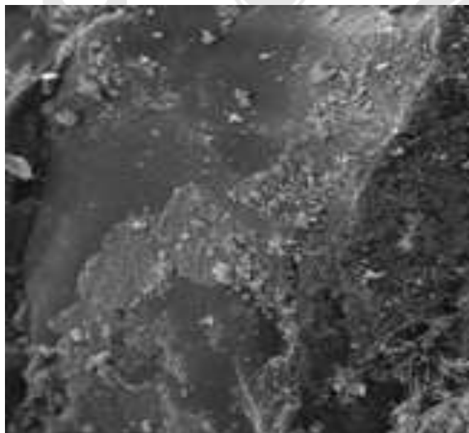
Figura 2 – Micrografia (ampliação em 5000x) obtida para o concreto de referencia.
