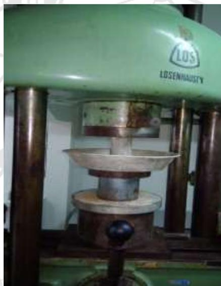
**Figura 3:** Rompimento dos corpos de prova
