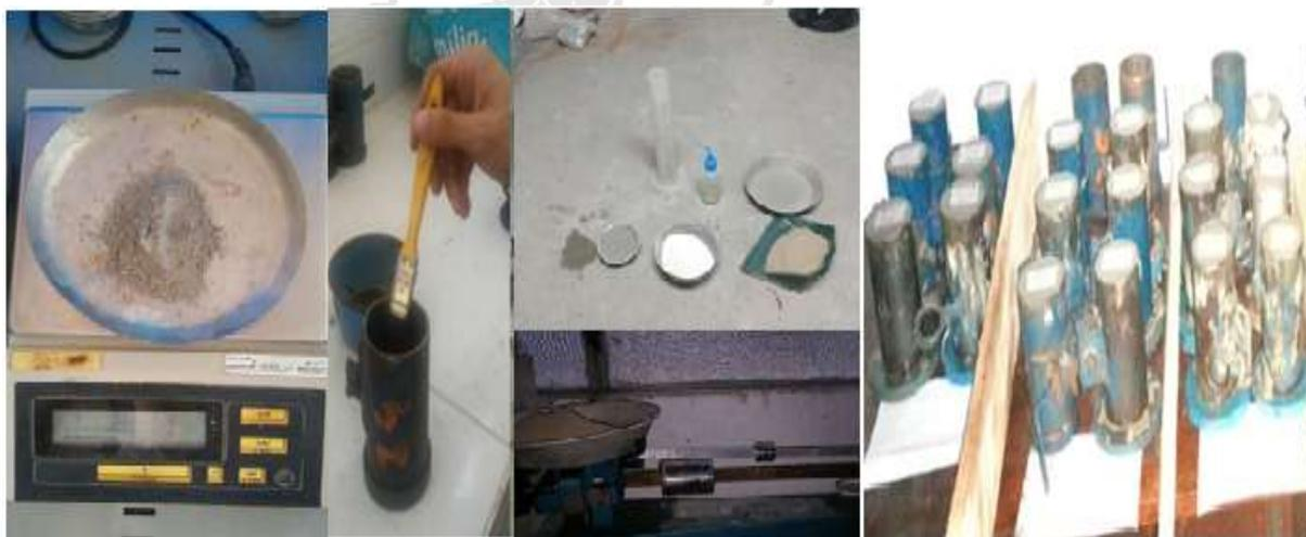
**Figura 2:** Produção dos corpos de prova de argamassa
