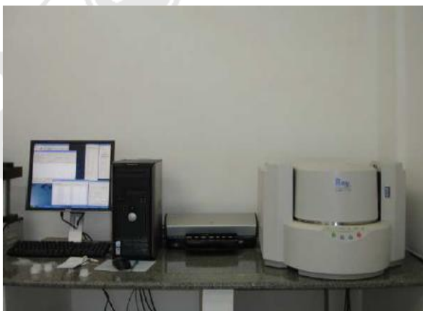
Figura 3: Equipamento EDX utilizado para realização do ensaio.
