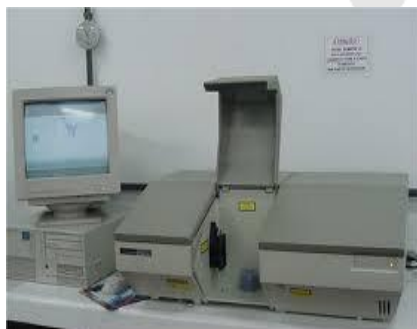
Figura 5: Equipamento utilizado para realização do ensaio de FTIR- Espectroscopia na região do infravermelho com Transformada de Fourier.
