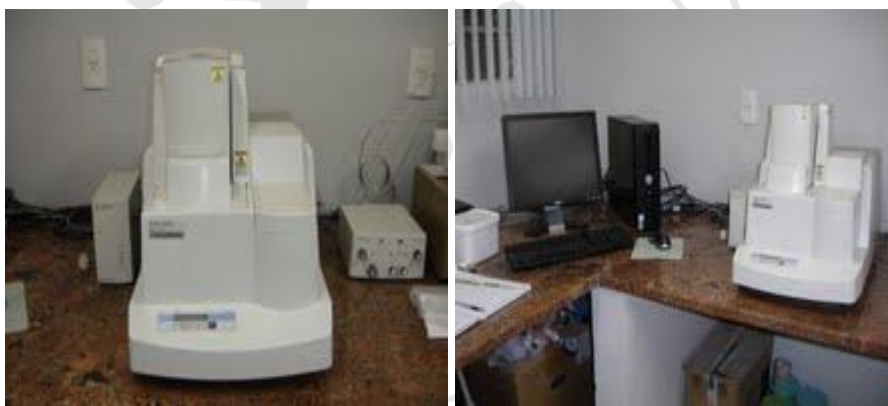
Figura 4: Equipamento para análises térmicas diferenciais (ATD) e termogravimétricas (TG).
