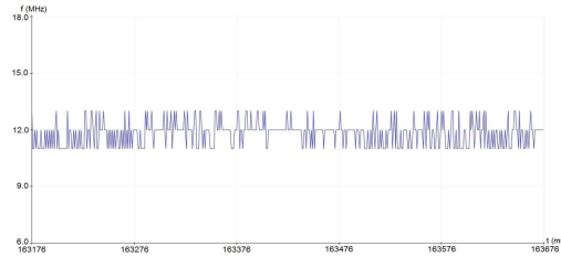
Gráfico 8 - Sinal da Antena com o Sol no Foco do LNB
