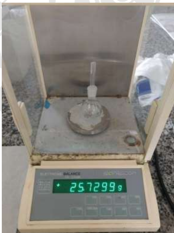
Figura 1: Efetuação da pesagem do picnômetro vazio para realização do teste de densidade.
