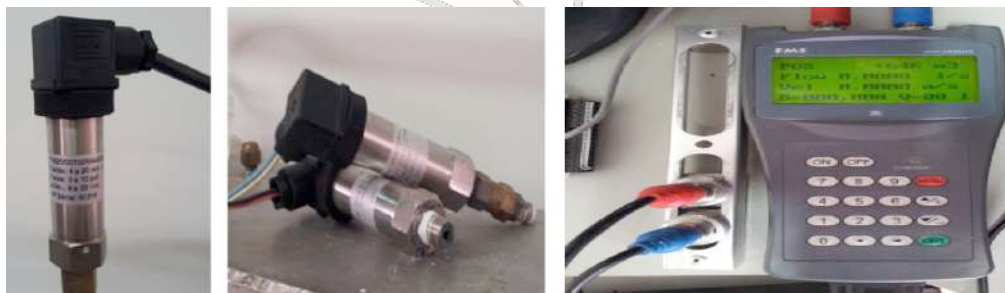
Figura 2. Transdutores de Pressão/Medidor Ultrassônico.
