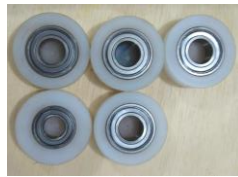
Figura 3 – Mancais de Poliamida 6 e rolamentos acoplados
