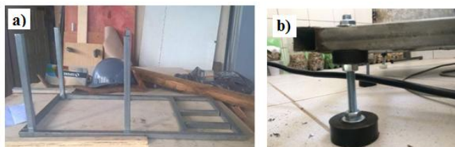
Figura 8 – a) Construção da base; b) Suportes ajustáveis da estrutura.
