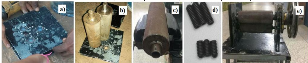
Figura 7 – a) União das duas chapas de aço com parafusos; b) Acoplamento dos rolos nos rolamentos; c) Rolo com furo roscado; d) Parafuso prisioneiro e) Rolo unido à polia com parafuso
