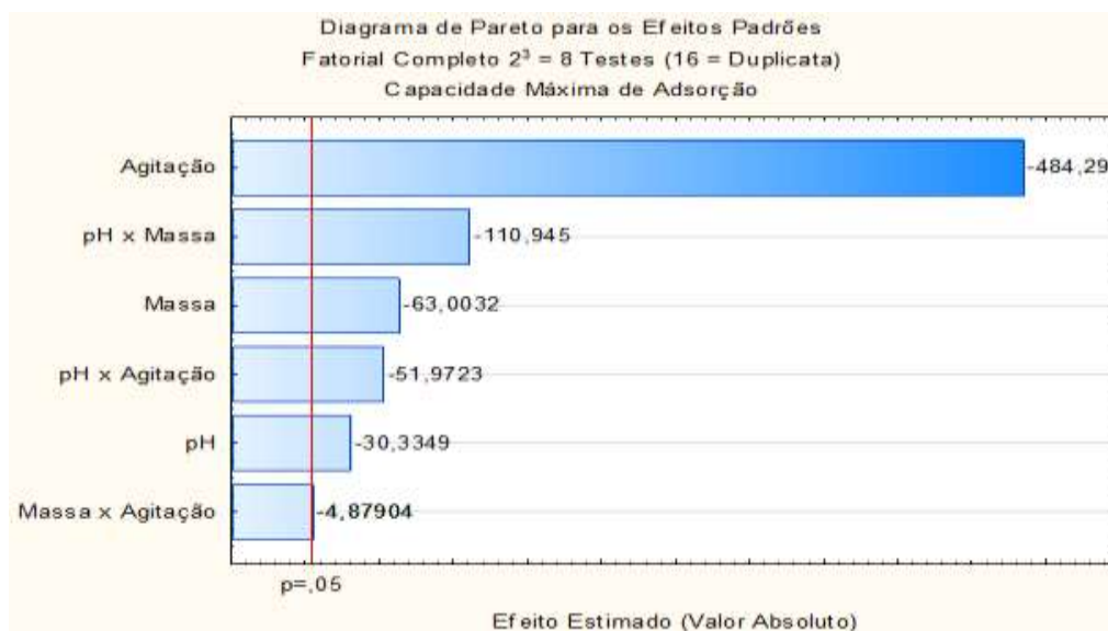
Figura 2: Diagrama de Pareto para Água com Bactéria Tratada com Carvão Ativado
